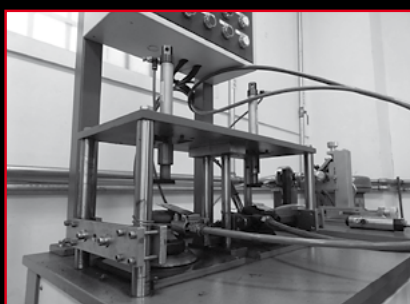
Испытательный стенд для пневматических орбитальных шлифовальных машин.
